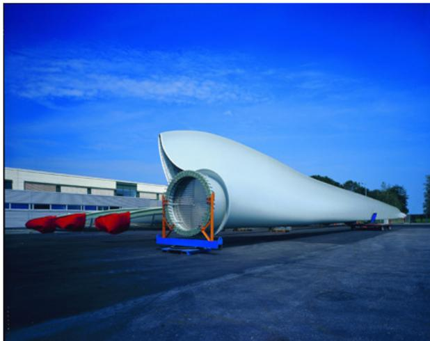
Rotorblatt mit Hinterkantensegment
