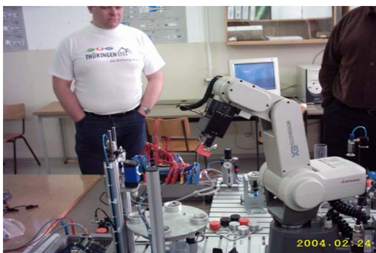
Roboter über Bohrwerk
